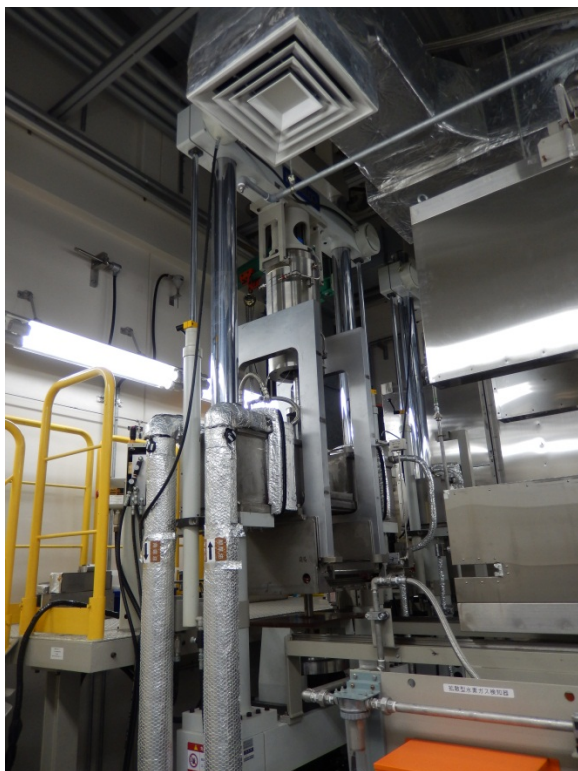
図表 4 120MPa 水素ガス中疲労試験機
