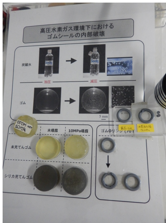
図表 5 高圧水素中のゴムシールの挙動例
